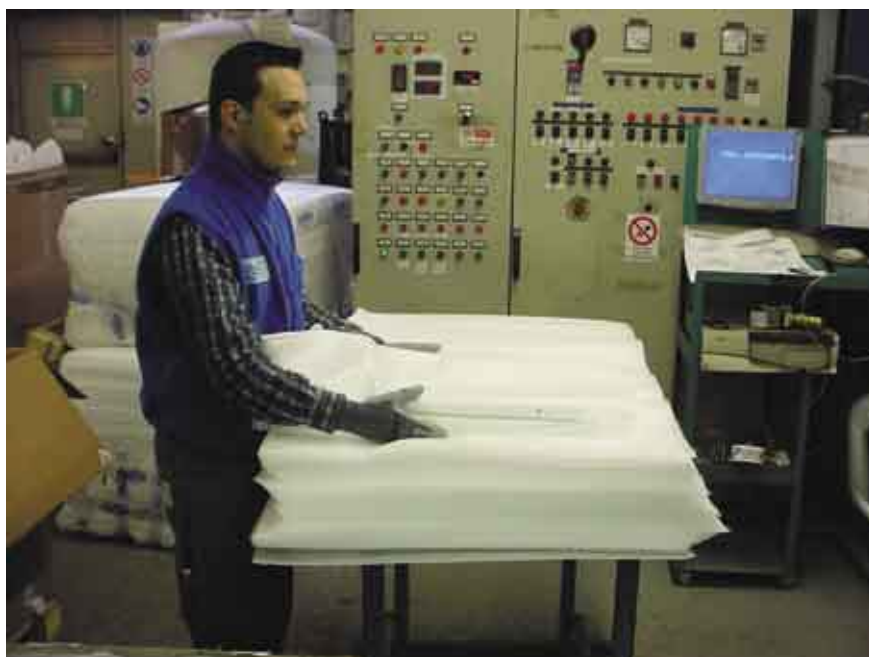
Fig. 10 - L'imballaggio dei pezzi dopo la polimerizzazione e i controlli qualitativi.
